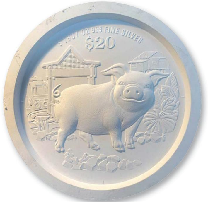
*Gipsmodelle dienten früher für die Auswahl und Bearbeitung des Entwurfes sowie als Vorlage für den Stempel – hier ein Beispiel von der Singapur Mint. Heute arbeitet man mehr mit digitalen Entwürfen, die in Kunststoff umgesetzt werden, oder verzichtet völlig auf ein physisches Modell.*
